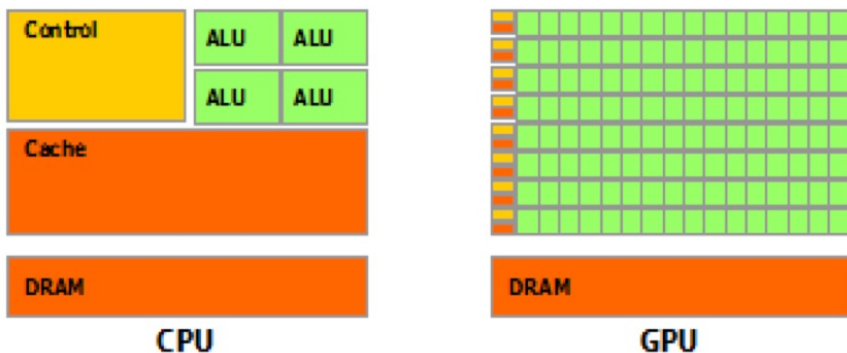
Fig.8: La GPU asigna más transistores al procesamiento de datos.
